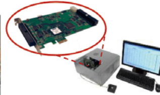
ネットワークアナライザー (水晶振動子用の計測器)
